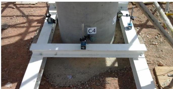
Figure 8. In situ test on the pile / Prove in situ sul palo.
