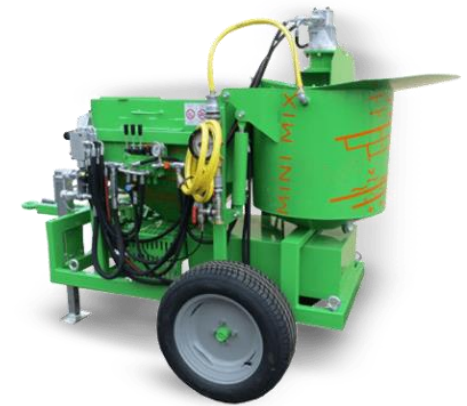
Impianto di miscelazione e iniezione (cortesia DAI PRA Srl)
