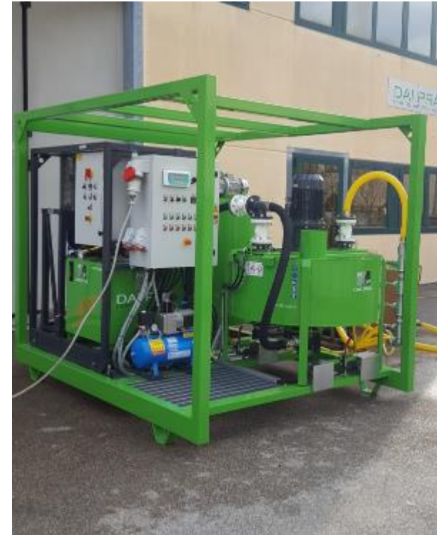
Impianto di miscelazione e iniezione (cortesia DAI PRA Srl)
