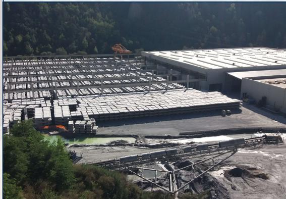
**Getto cls:** 124 casseri vibranti statici, maturazione a vapore e T° controllata, ciclo termico monitorato, gradiente max 20°C / h, T° max 55° C.
