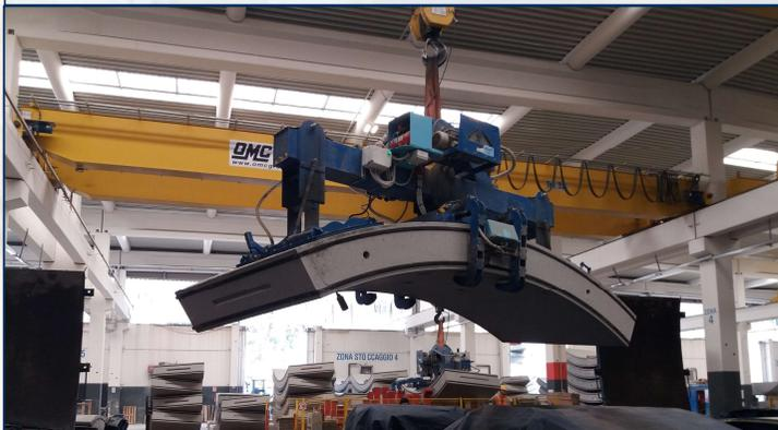
**Assemblaggio armatura:** acciaio B450C.
