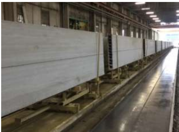
Figure 18. Vertical demoulding on trolleys line in factory for further finishing operations Scassero e posizionamento su linea di carrelli in stabilimento per le successive operazioni di finitura
