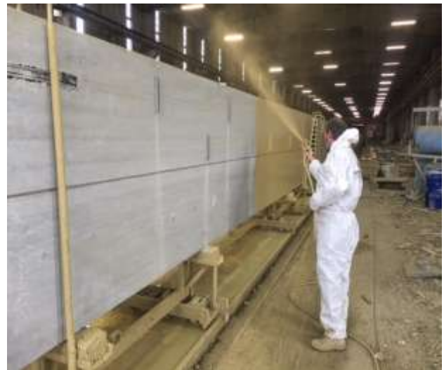
Figure 21. Double painting coat of special paint TiO 2 type Doppia mano di vernice speciale al Titanio
