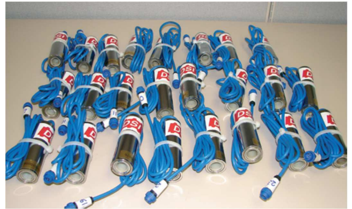
Figura 3. Sensori magnetoinduttivi per la misura della forza di cavi non aderenti
