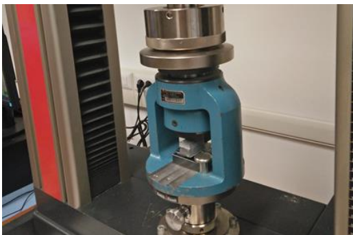
Figure 2. Compression test activity / attività di test a compressione
