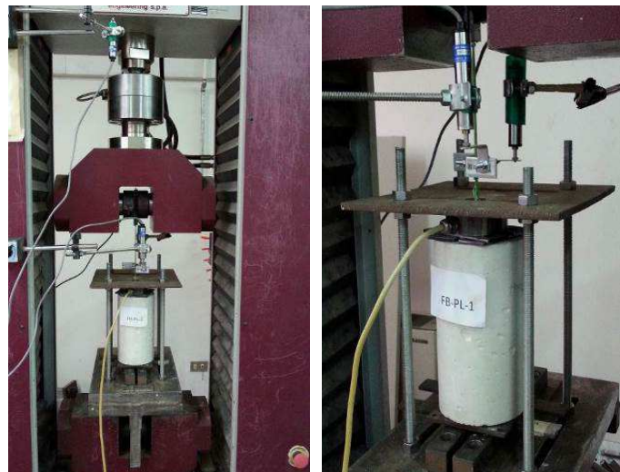
Figure 4. Bond test set-up / Set-up della prova di aderenza,
