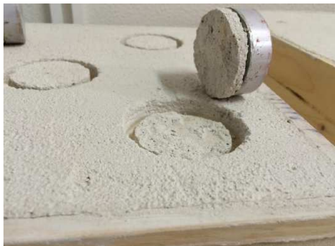
Figure 3. Powders compacting system / Prova di aderenza, frattura tipo B.
