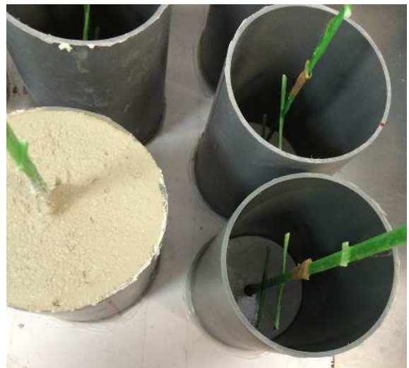
Figure 5. Specimens for the bond test / Campioni per la prova di aderenza
